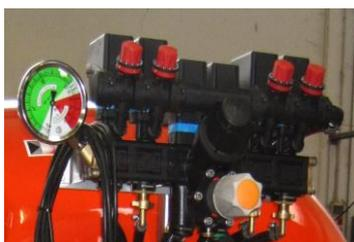
Kit valvole motorizzate con apertura destra/sinistra indipendente, valvola elettrica di regolazione della pressione e chiusura generale elettrica, filtro auto-pulente ed il grande manometro  $\varnothing$  100 mm.
