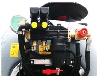
Kit valvole motorizzate con apertura destra/sinistra indipendente, valvola di Regolazione pressione manuale, filtro auto-pulente, manometro  $\varnothing$  100 mm.
